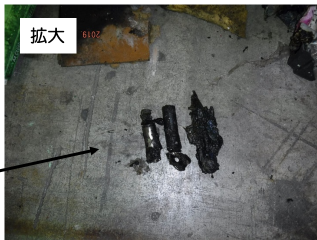
火元となった充電式電池
