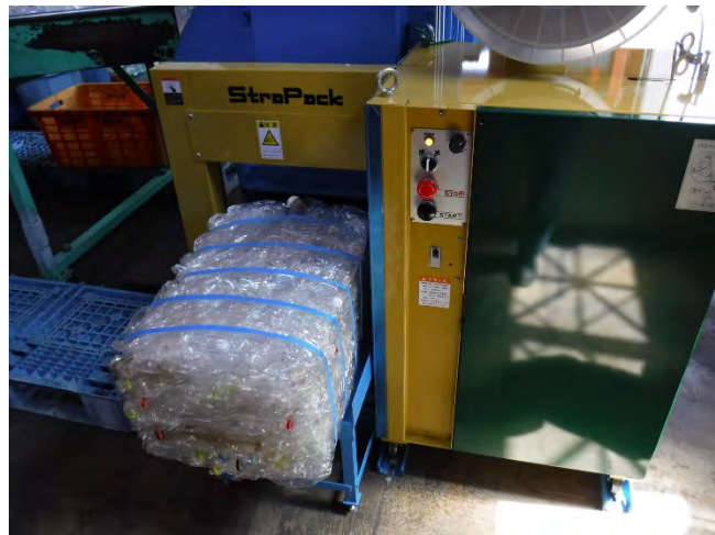
ペットボトル圧縮梱包機で圧縮・梱包します。(640 mm×430 mm×350 mm)
