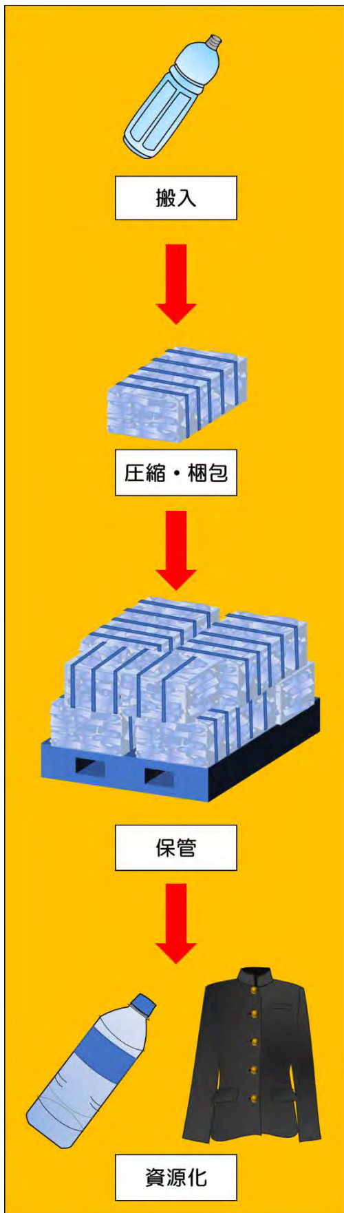
ペットボトル圧縮梱包機で圧縮・梱包します。(640 mm×430 mm×350 mm)
